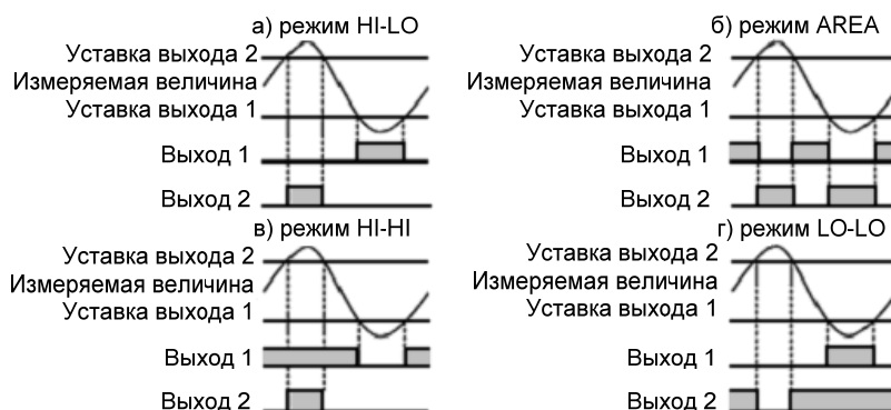
Рис. 5.20. Временные диаграммы режимов работы выходов
