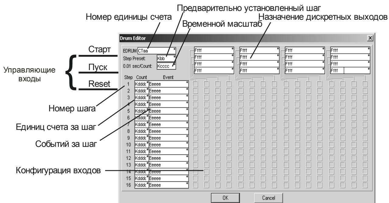
Рис. 5.19. Барабанный командоаппарат с дискретными входами и переходом по событию (EDRUM)
