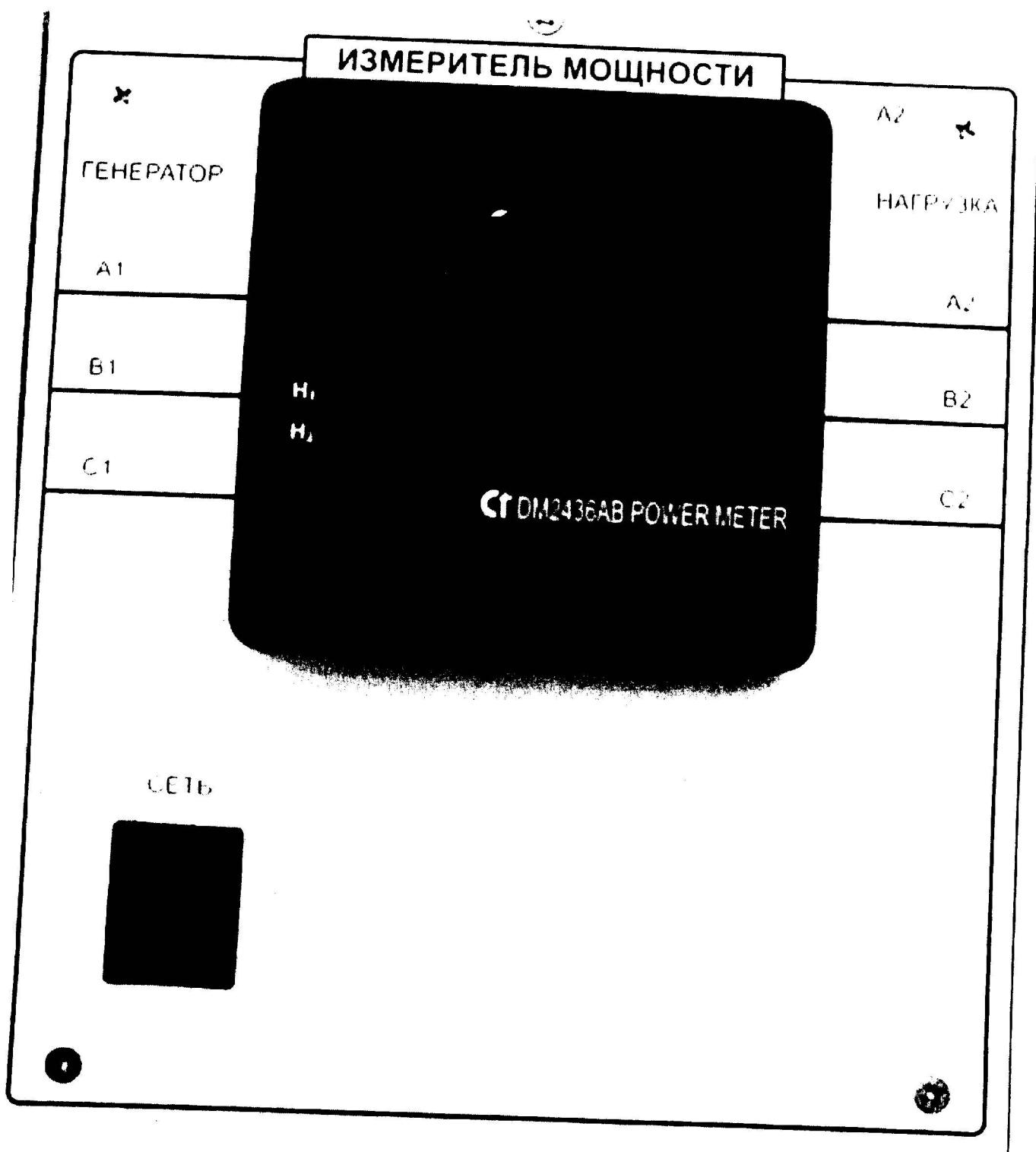
Рис. 1.2.2. Внешний вид модуля А2 «Измеритель мощности»
